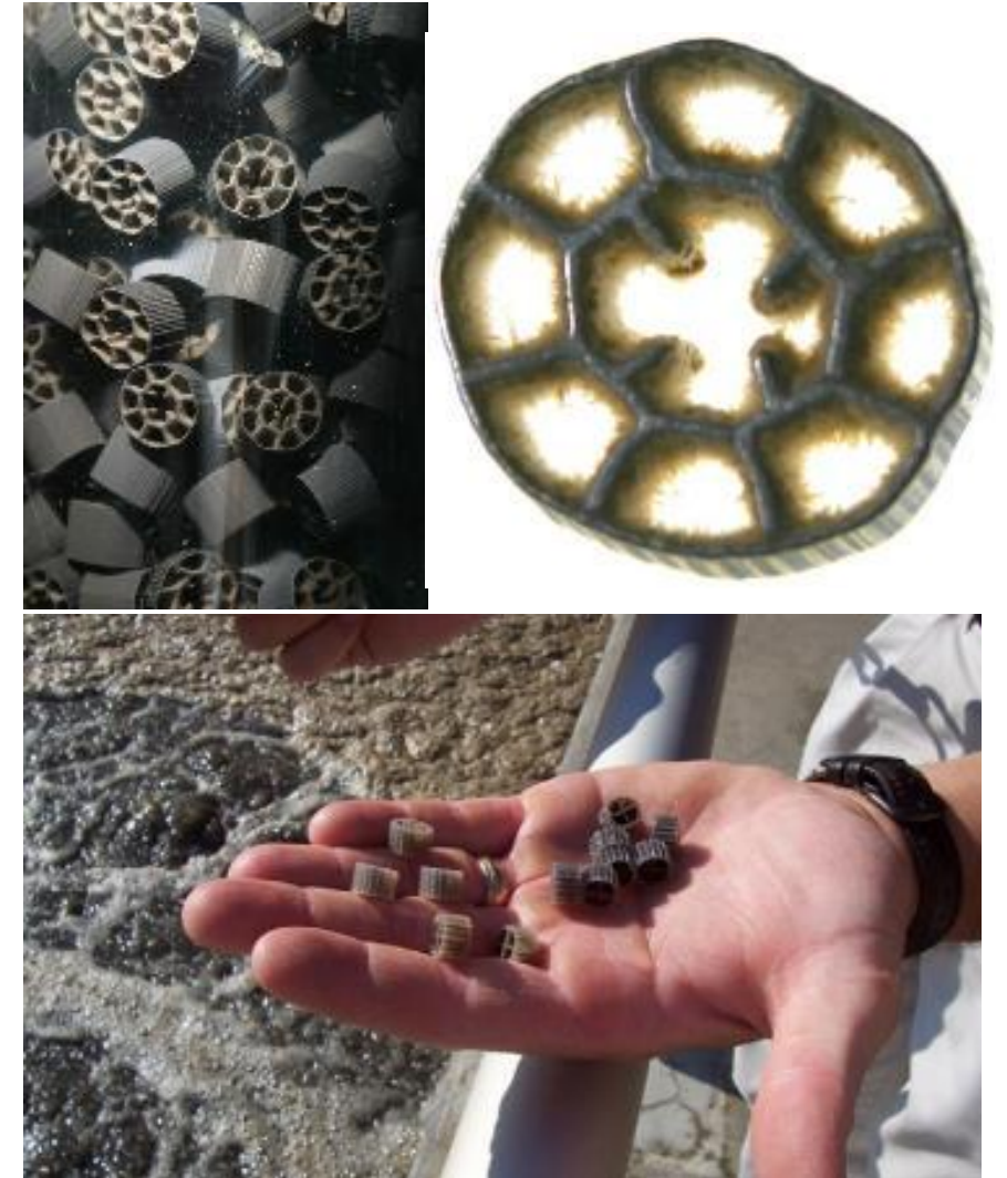
Medio de soporte para lecho suspendido
