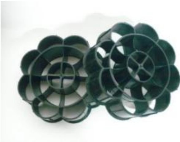
Tipo de medio de soporte inadecuado para el caso de estudio
