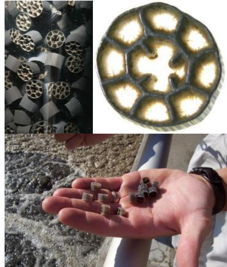
Medio de soporte para lecho suspendido
