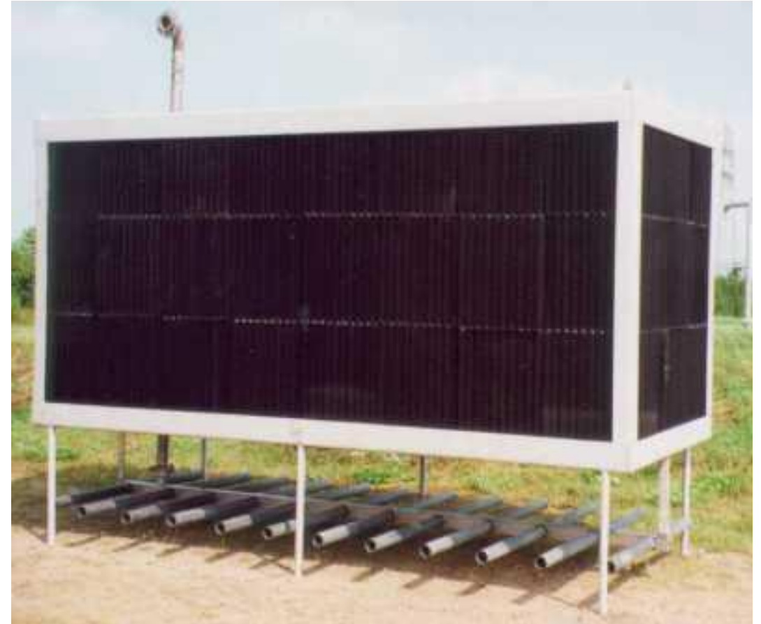
Arreglo típico del medio de soporte y difusores
