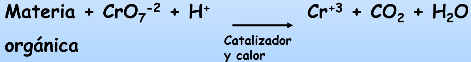
La prueba de la DQO se utiliza para medir el contenido de materia orgánica en aguas residuales y naturales
