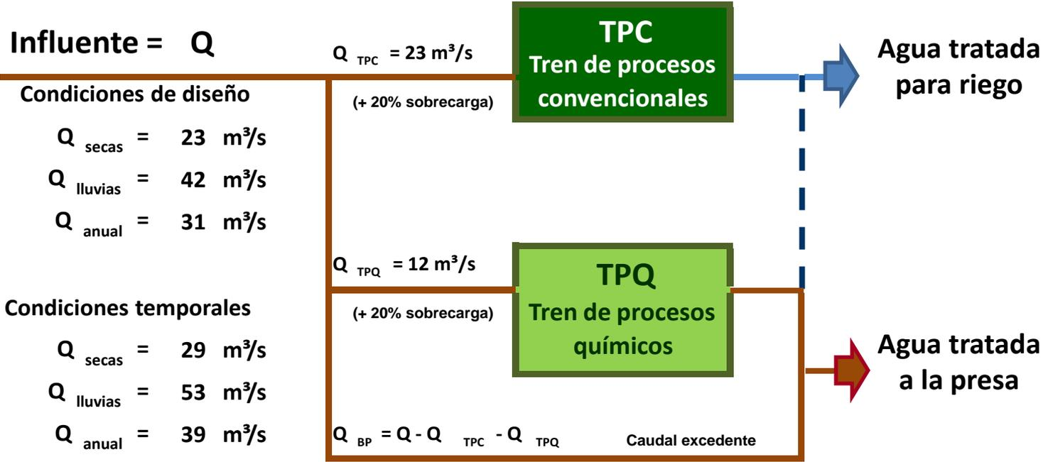
La P.T.A.R. Atotonilco tendrá una capacidad nominal de tratamiento de  $23 \text{ m}^3/\text{s}$ , con una capacidad adicional para el tratamiento en forma temporal de los picos de aguas de lluvia por  $12 \text{ m}^3/\text{s}$  adicionales, lo que da una capacidad acumulada de  $35 \text{ m}^3/\text{s}$ .
