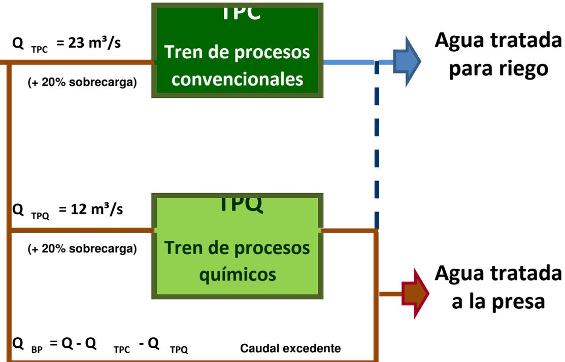
La P.T.A.R. Atotonilco tendrá una capacidad nominal de tratamiento de  $23 \text{ m}^3/s$ , con una capacidad adicional para el tratamiento en forma temporal de los picos de aguas de lluvia por  $12 \text{ m}^3/s$  adicionales, lo que da una capacidad acumulada de  $35 \text{ m}^3/s$ .
