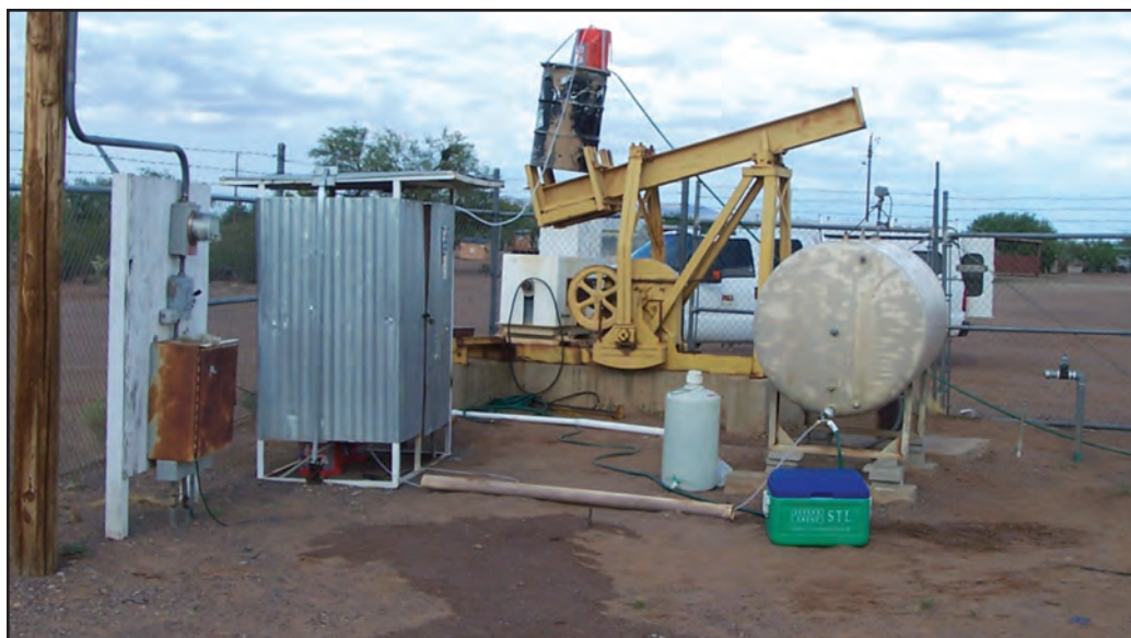
Investigadores de la Universidad Estatal de Arizona prueban un sistema de tratamiento de bajo costo para eliminar arsénico y nitratos del agua subterránea en las tierras de los Tohono O'odham, cerca de Sikul Himatk, Arizona.
