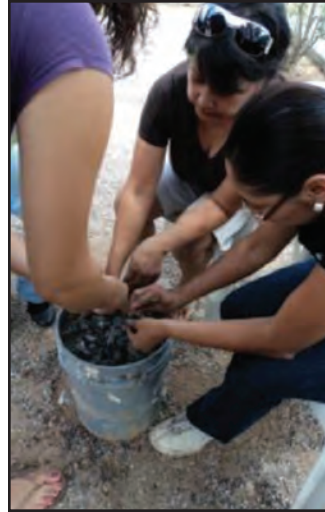
Los participantes de un taller aprenden a fabricar ladrillos de concreto fibroso utilizando una mezcla de papel de desecho, cemento y arena.
