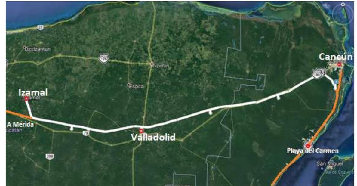
Este tramo utilizará el actual derecho de vía de la carretera 180-D (Kantunil – Cancún) por un total de 225 kilómetros. Solo en sus extremos, 21 km al inicio y 7 al final la vía no aprovecha el derecho de vía de la carretera
