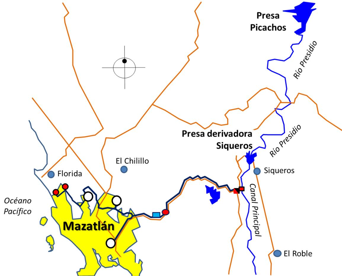
En la primera etapa está previsto tomar el agua del Canal Principal margen derecha a 5,8 km aguas abajo de la presa derivadora “Siqueros”, a la altura del poblado “El Tecomate de Siqueros”.
